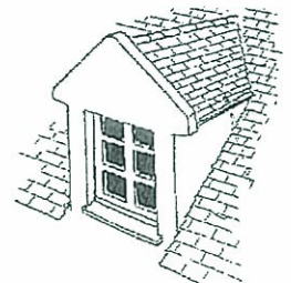
Lucarne à pignon
