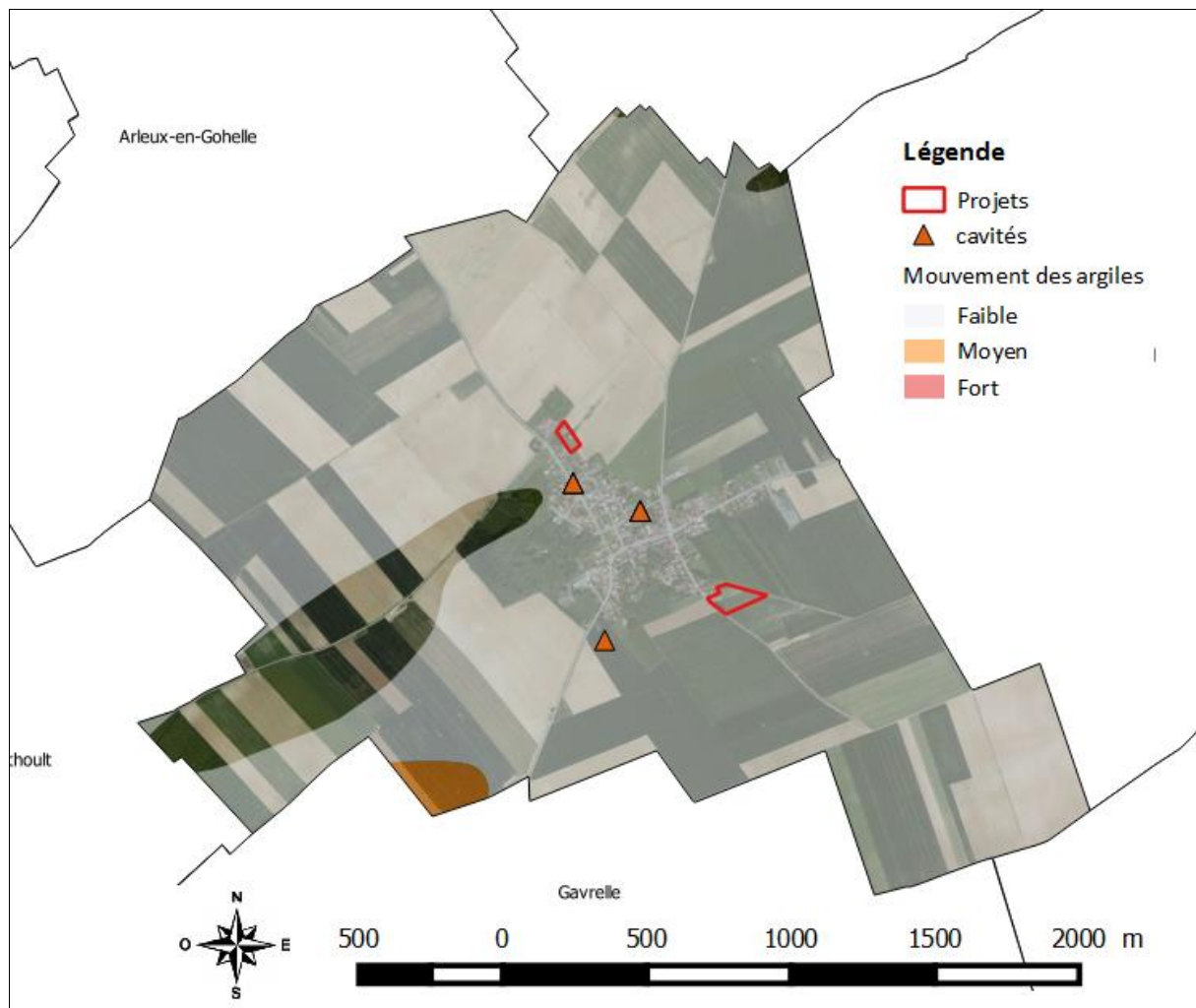
Risque de mouvement des argiles et localisation des cavités souterraines à risque d'effondrement
