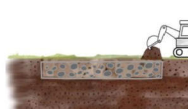
La tranchée drainante
