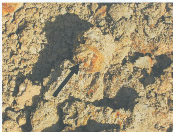
Traces d'hydromorphie importantes (taches de rouille) et amas ferro-manganiques (flèche) dans les horizons de profondeur (4 mètres).
