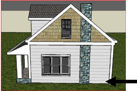
Substruction apparente traitée à l'identique du reste de la façade
