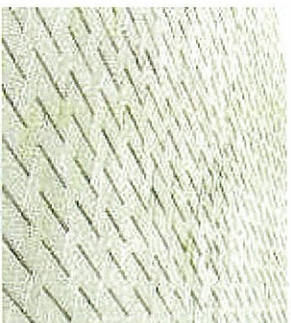
Les pavés en béton poreux et drainants (HQE)
