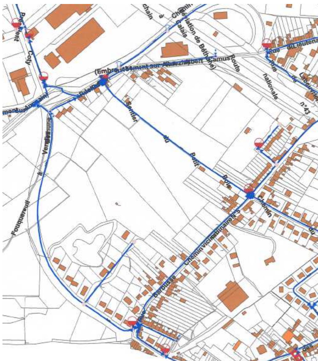
Extrait du plan de réseau d'eau potable
