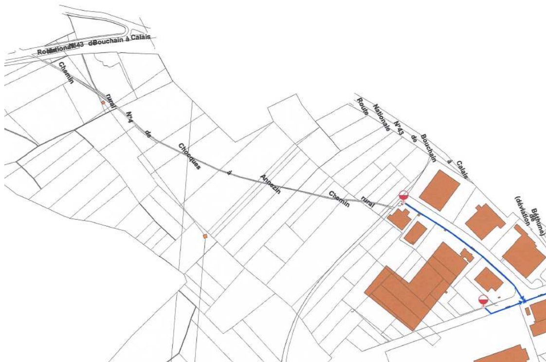
Extrait du plan de réseau d'eau potable
