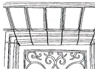
Encadrement de portillon en pierre de taille moulurée avec de minces joints à la chaux entourant une ferronnerie
