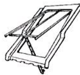
Châssis à tabatière, fenêtre de toit traditionnelle présente sur le bâti ancien, à cadre léger dont l'ouvrant est à projection
