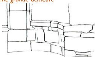
Mur de clôture en moellon calcaire jointoyé à la chaux avec harpe en pierre de taille et mur bahut en pierre marquant une place en arc de cercle devant l'entrée d'une grande demeure
