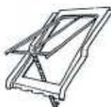
Châssis à tabatière appelé aussi vasistas, c'est la fenêtre de toit traditionnelle présente sur le bâti ancien, à cadre léger en tôle galvanisée dont l'ouvrant est à projection
