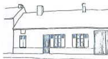
La finition de la façade doit être plane pour laisser la pluie glisser et ne pas accrocher les poussières
