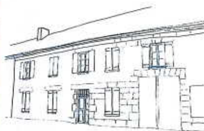
Les ouvertures des grandes maisons sont marquées par les encadrements ou pierre, les ferronneries des garde-corps, les feuillures dans lesquelles les volets fermés s'encastrant
