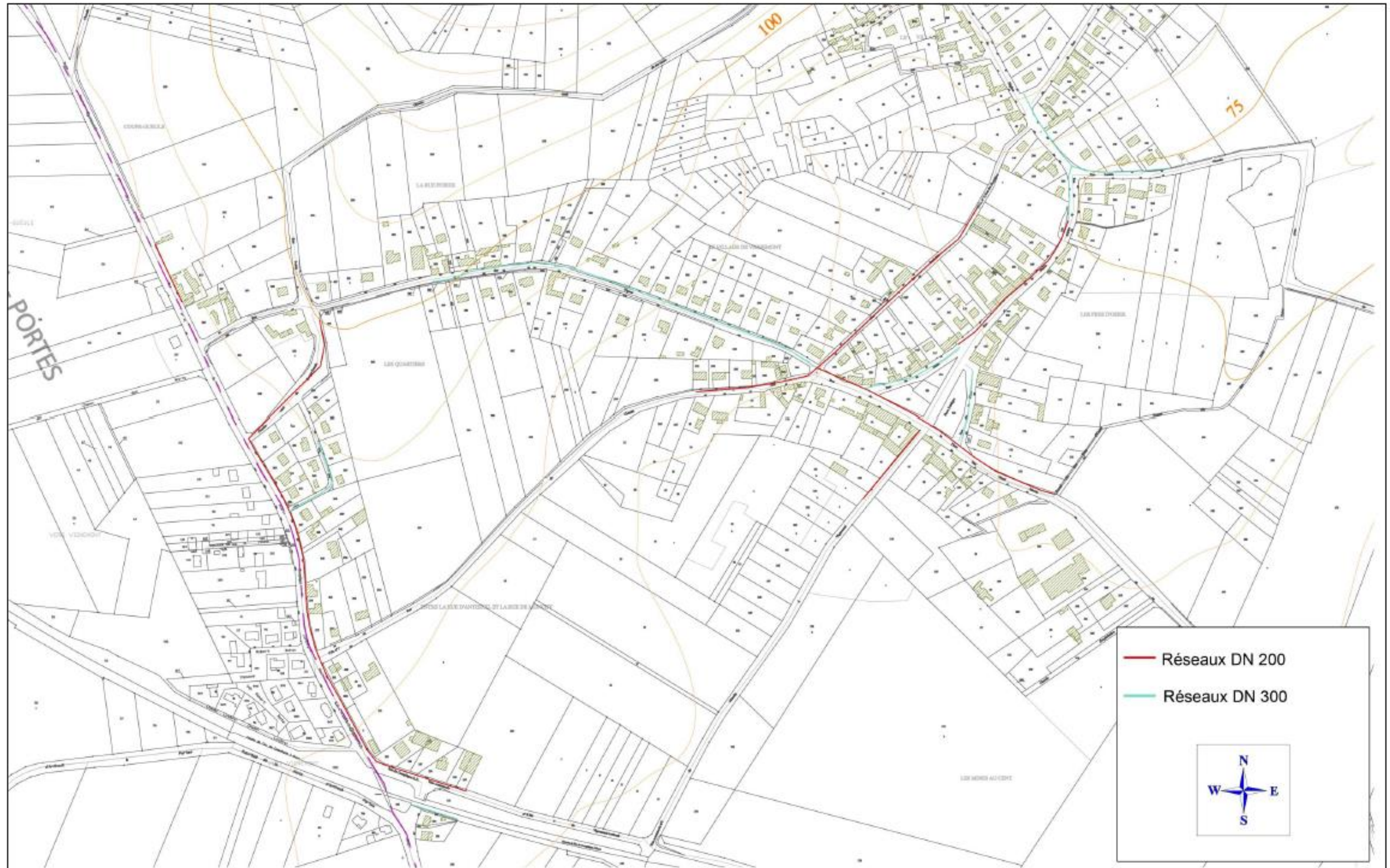
Figure 9 : Plan du réseau d'eaux pluviales (Source : Zonage d'assainissement des eaux pluviales – ARTEMIA ENVIRONNEMENT)
