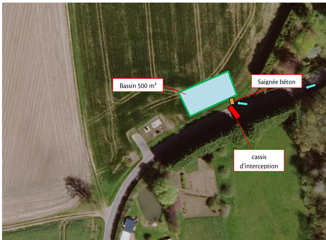
Figure 99. Aménagement d'un bassin au bas de la Grande Rue
