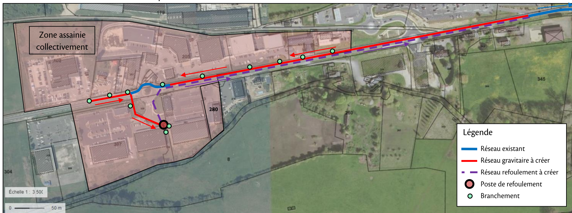
Figure 25. Proposition d'un scénario de raccordement alternatif de la zone commerciale
