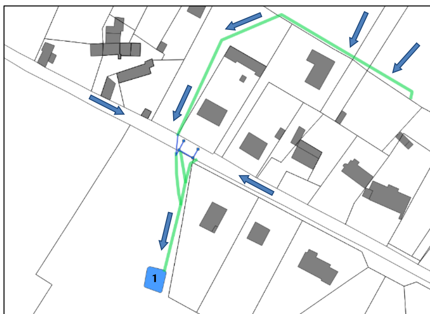
Figure 42. Schéma fonctionnel du bassin 1
