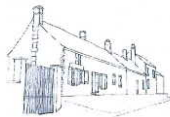
Les ouvertures sont inscrites aléatoirement dans la façade mais les linteaux sont alignés
