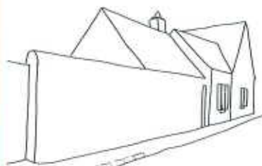
Les murs des maisons rurales s'enchaînent avec les murs de clôture
