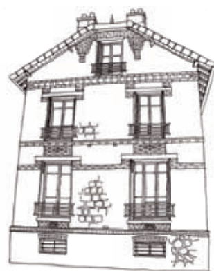
Les débords de toit, les avancées en pignon, les modénatures sont caractéristiques de ces façades
