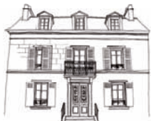
Les lucarnes des combles sont alignées aux baies des étages inférieurs
