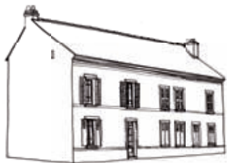
Les nombreux percements sont ordonnés et hiérarchisés sur les 2 niveaux et les baies des combles de la façade des grandes maisons
