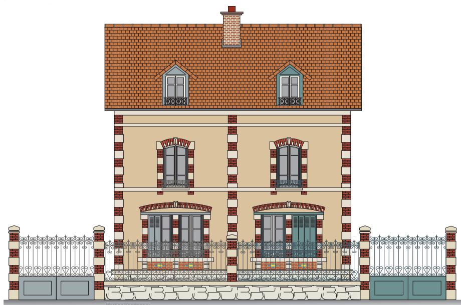
Les débords de toit, les avancées en pignon, les modénatures sont caractéristiques de ces façades
