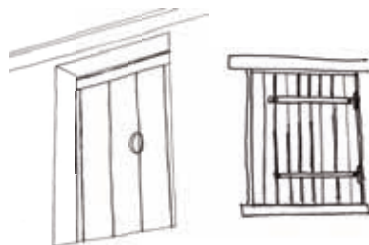
Contrevents en bois plein constitués de lames verticales assemblées par des barres horizontales métalliques ou en bois
