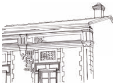
Façade en brique et chaînage en pierre de taille souligné par des modénatures en pierre et/ou plâtre
