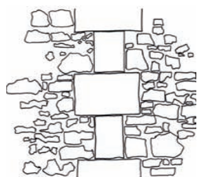
Harpe en pierre de taille assurant la rigidité d'un mur dressé en moellon
