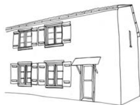
La finition de la façade doit être plane pour laisser la pluie glisser et ne pas accrocher les poussières
