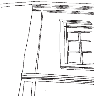
Harpe, corniche bandeau, en enduit lissé soulignant l'architecture d'une façade de maison de village
