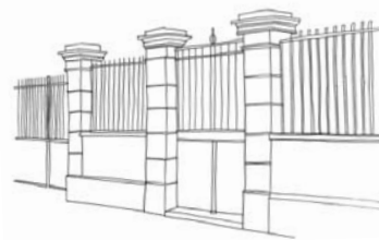
Clôture en moellon calcaire et grès rejointoyés à la chaux avec piles en pierre de taille
