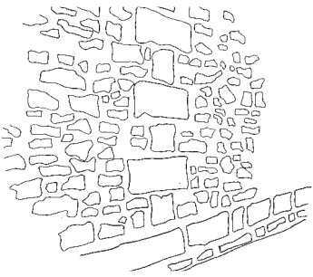
Harpe en pierre de taille d'un mur en moellon calcaire et grès
