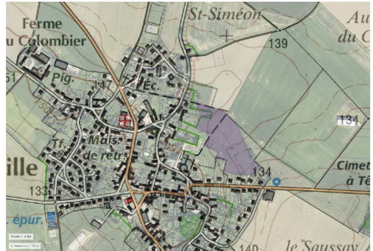
Emprise de la zone 2AU (en violet) et relief constaté : le point bas du léger talweg est situé en dehors du secteur urbanisable.
