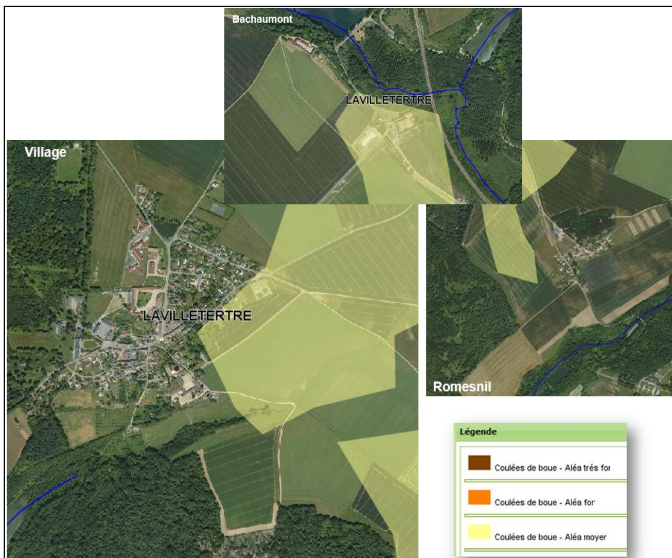
Figure 63 : Risques de coulées de boue sur les entités bâties (source : DDT60)
