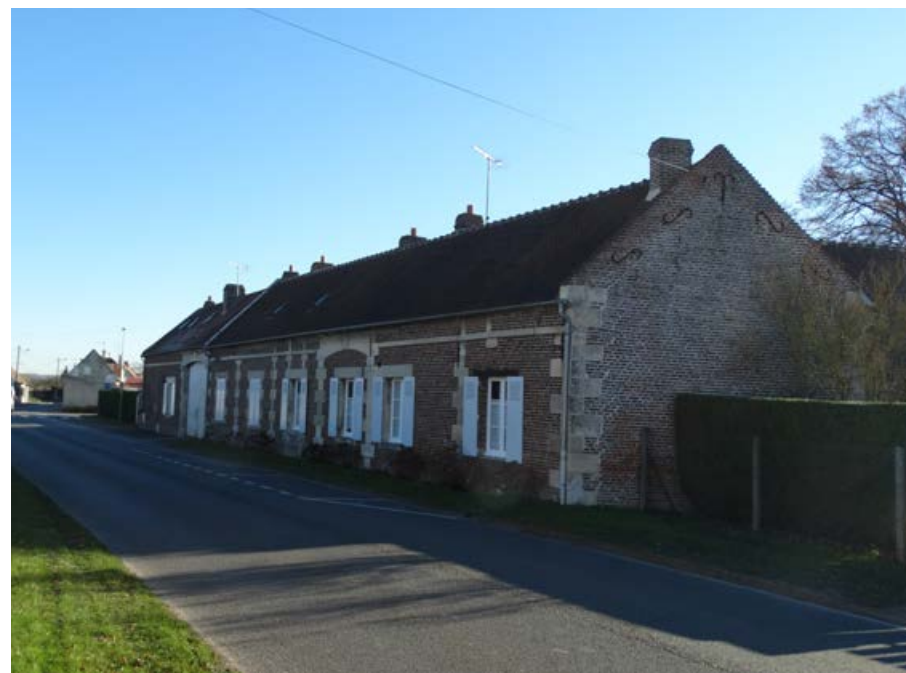
Maison rurale alignée sur rue, avec briques, moellons et pierre de taille en ornement.
