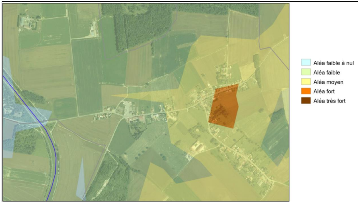
Figure 52 : Risques de coulées de boue (village)
