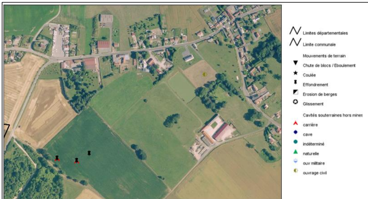
Figure 57 : Cavités souterraines et mouvements de terrain associés
