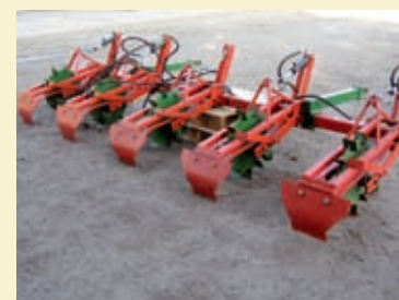
Autre possibilité : pelles à installer à l'arrière de la butteuse
