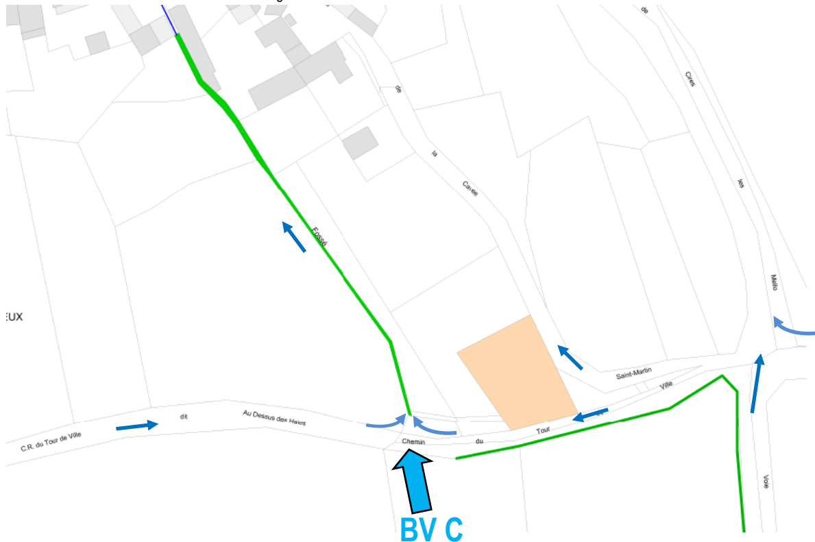
Figure 26. Ecoulements au niveau du cimetière
