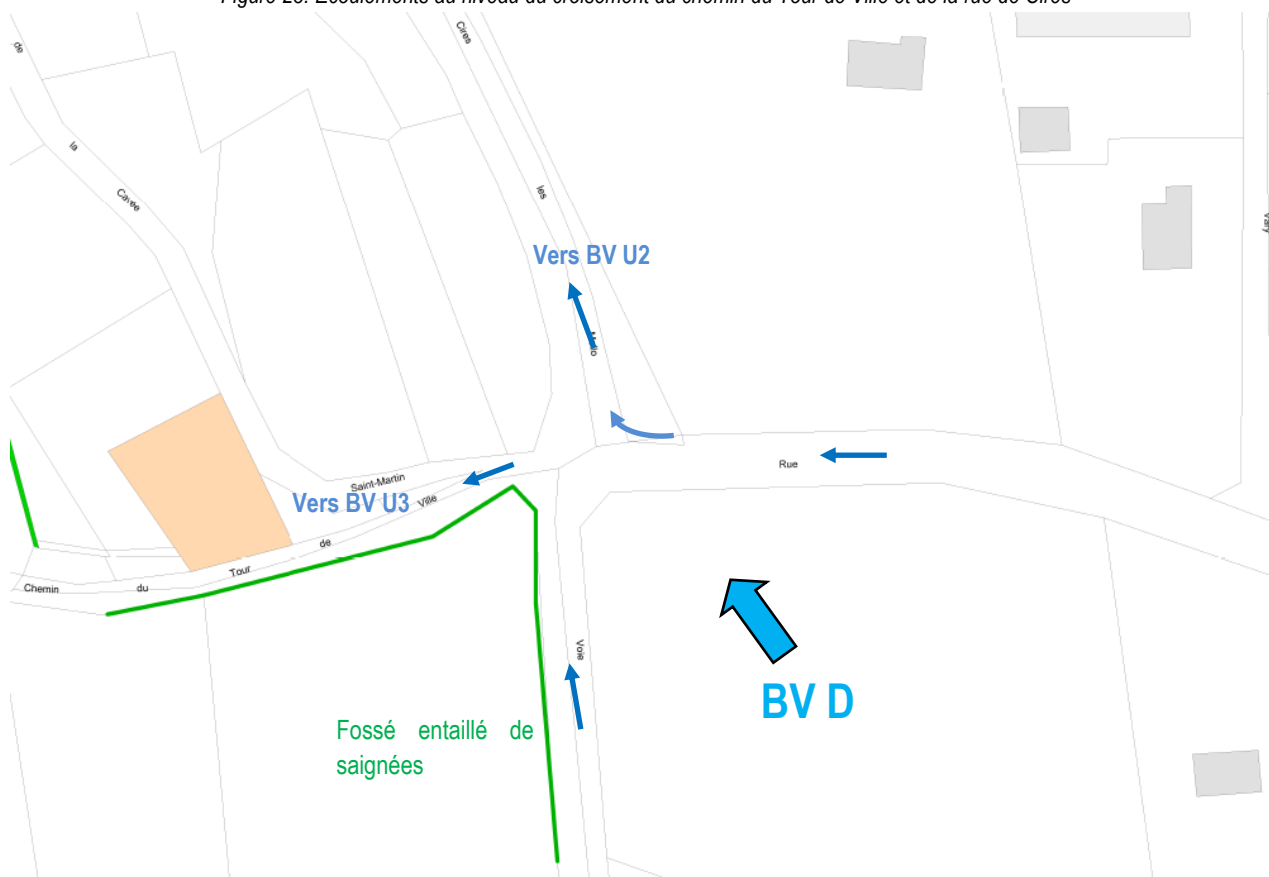
Figure 23. Ecoulements au niveau du croisement du chemin du Tour de Ville et de la rue de Cires
