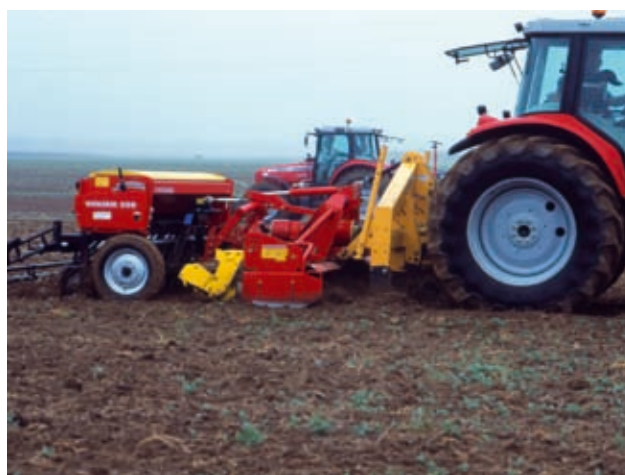
Semis avec combiné décompacteur-semoir
