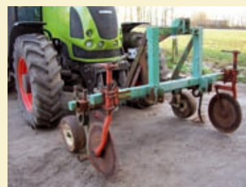
Des disques à l'avant des pioches évitent les bourrages en coupant les résidus
