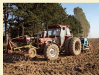
Un tasse-avant et des roues jumelées sur le tracteur limitent les risques de compaction du sol
