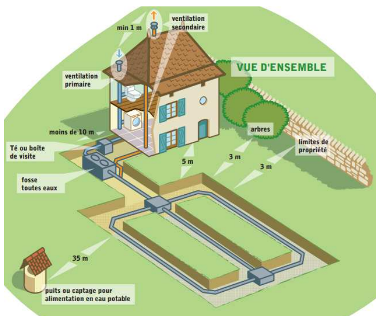
Figure 3 : Description des tranchées d'épandage à faible profondeur (source : SPANC)
