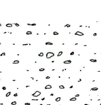
Mur en moellon enduit à pierre vue
