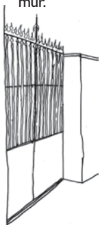
Grille en fer forgé, pleine sur les deux tiers avec barreaux droits terminés en fer de lance sur le tiers supérieur
