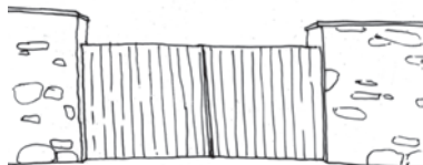
Portail simple en bois avec assemblage vertical. Mur et portail suivent la pente de la rue
