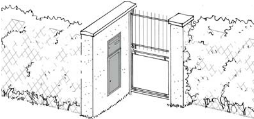
Pose latérale : les coffrets techniques et la boîte aux lettres peuvent être associés
