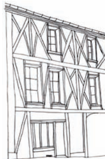
Les structures en pan de bois sont rares et, dans la plupart des cas, protégées par un enduit. Ci-contre, cette maison a perdu son enduit : les pièces de bois risquent de pourrir si elles sont laissées à l'air libre
