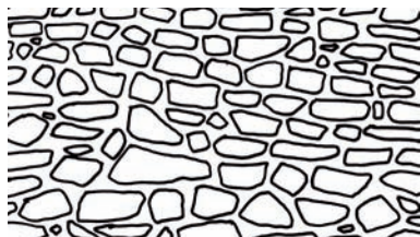
Appareillage de grès de qualité médiocre : les joints sont trop larges et les moellons mal agencés ; ce type de maçonnerie est normalement masqué par un enduit
