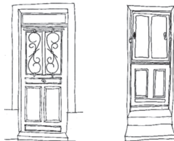
Portes en bois avec parties centrales vitrées protégées par une ferronnerie (à gauche) et un volet plein amovible (à droite)
