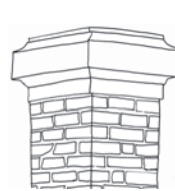
Chapeau en pierre de taille (calcaire) protégeant un pilier de brique
