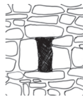
Chantepleure aménagée dans un mur de soutènement
