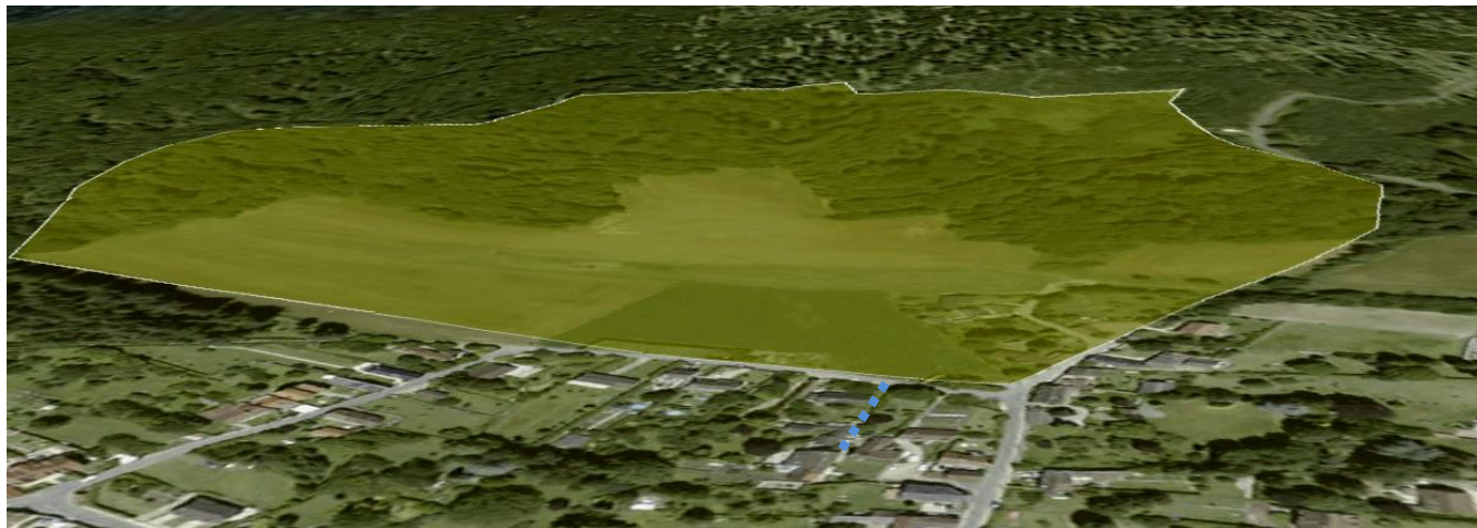
Bassin versant capté par le drain
