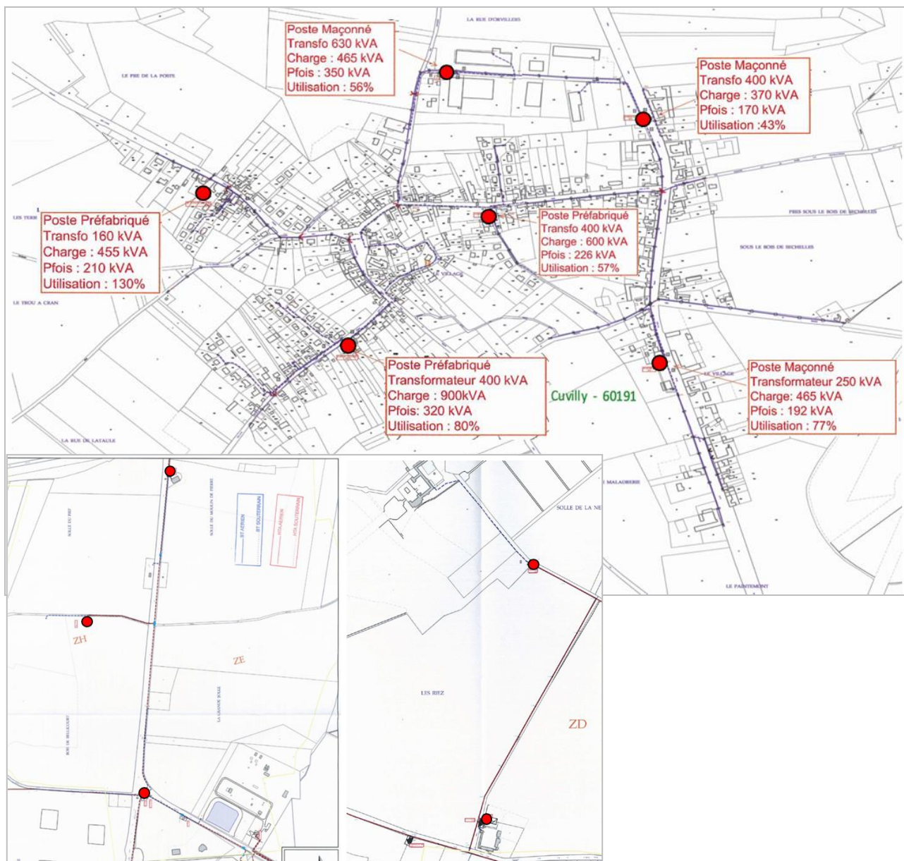
Figure 11 : Plan du réseau électrique tension (Source : SICAE)
