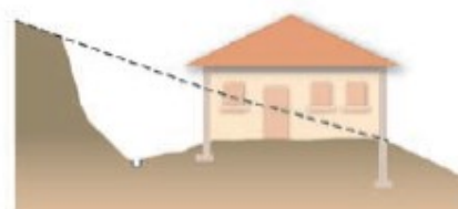
Plate-forme en déblais
