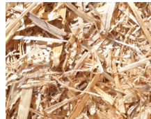
PAILLE DE CÉRÉALES durée de vie : 1 an et plus / épaisseur : 15-20 cm
