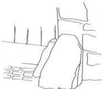
Bornes et de chasse-roues en grès protégeant les angles du mur
