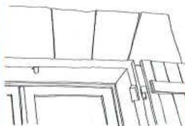
Feuillure dans laquelle s'encastre un volet et encadrement en pierre de taille
