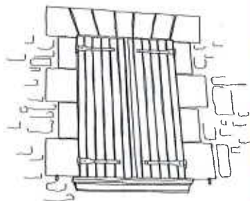
Volets en bois plein avec éléments de ferrures et encadrement en pierre de taille
