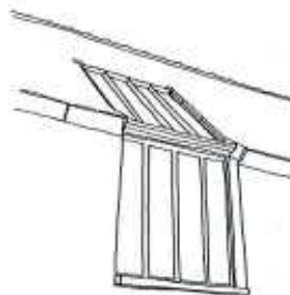
Prolongement de fenêtre à engranger dans le toit pour éclairer les combles sur un bâtiment coté cour comme une verrière d'atelier
