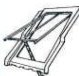
Prolongement de fenêtre à engranger dans le toit pour éclairer les combles sur un bâtiment coté cour comme une verrière d'atelier
