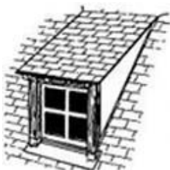
lucarne rampante ou en chien couché
