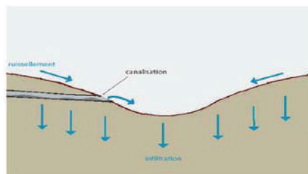
Schéma d'une noue de d'infiltration ( www.crit.archi.fr )
