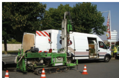
Foreuse hydraulique de type EMCI-700
