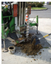
Foreuse hydraulique de type EMCI-700
