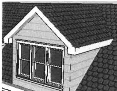
La lucarne est en saillie par rapport à la toiture.
