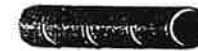
CANALISATIONS RIGIDES Ø100mm AVEC OUVERTURES Ø 10mm OU FENTES DE 5mm MINIMUM ESPACÉES TOUTES LES 10 À 15cm
