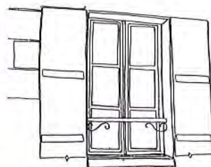
Volets en bois plein et garde-corps
