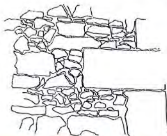
Harpe en pierre de taille d'un mur en moellon calcaire et grès
