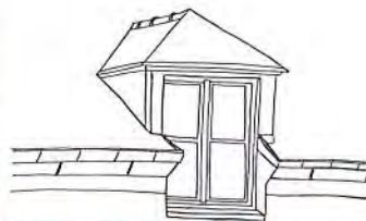
Lucarne capucine engagée dans le toit, maçonnée avec toiture à 3 pans
