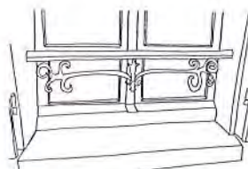
Appui de fenêtre en pierre et garde-corps en fonte
