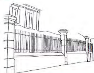
Ferronneries de clôture sur un muret en brique avec piliers en pierre de taille
