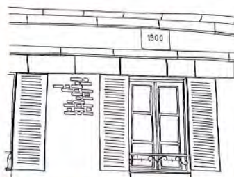
Les tableaux des fenêtres sont traités de la même façon que le mur de façade, simplement rejointoyés s'ils sont en brique ou en pierre de taille, enduits s'ils sont en moellon
