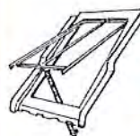
Chassis à tabatière, fenêtre de toit traditionnelle présente sur le bâti ancien, à cadre léger dont l'ouvrant est à projection
