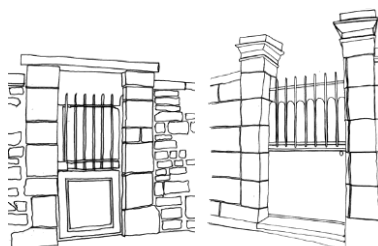
Encadrements de portillon en pierre de taille, l'un surmonté d'une dalle et l'autre formé de piles avec chapeaux
