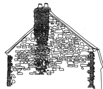
Pignon d'une maison en moellon à pierre vue avec harpes et souche de cheminée en brique
