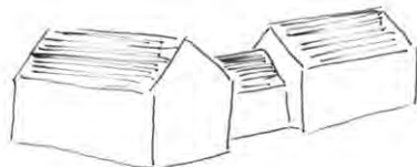
Corps de bâtiment en équerre
