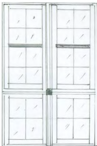
Fenêtre du XVII e Carreau de format carré Meneaux en bois
