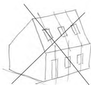
châssis trop nombreux
