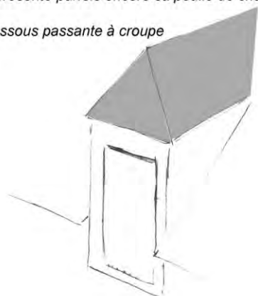
lucarne engagée dans le mur dite : pendante, fenière ou passante, elle présente parfois encore sa poulie de chargement
