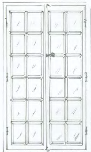
Fenêtre du XVIII e petits carreaux ouverture à la française Système à l'espagnolette.
