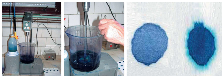
Matériel d'essai nécessaire (agitateur, bécher, pipette graduée) Prélèvement d'une goutte de solution Visualisation d'une tache de bleu sur papier filtre, (test positif à droite)
