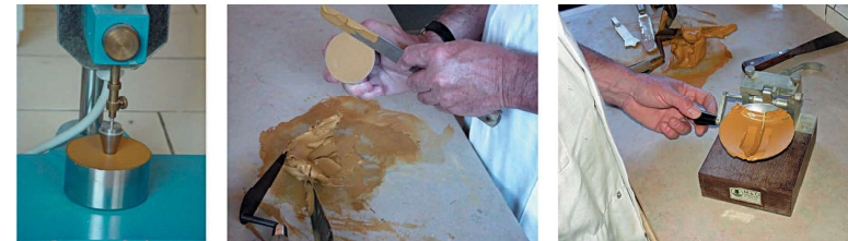
Figure 9 Détermination de la limite de plasticité au cône (à gauche) et à la coupelle de Casagrande (à droite) (Source Cerema)
