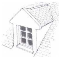
Lucarne pignon dont la façade repose à l'aplomb du mur gouttereau
