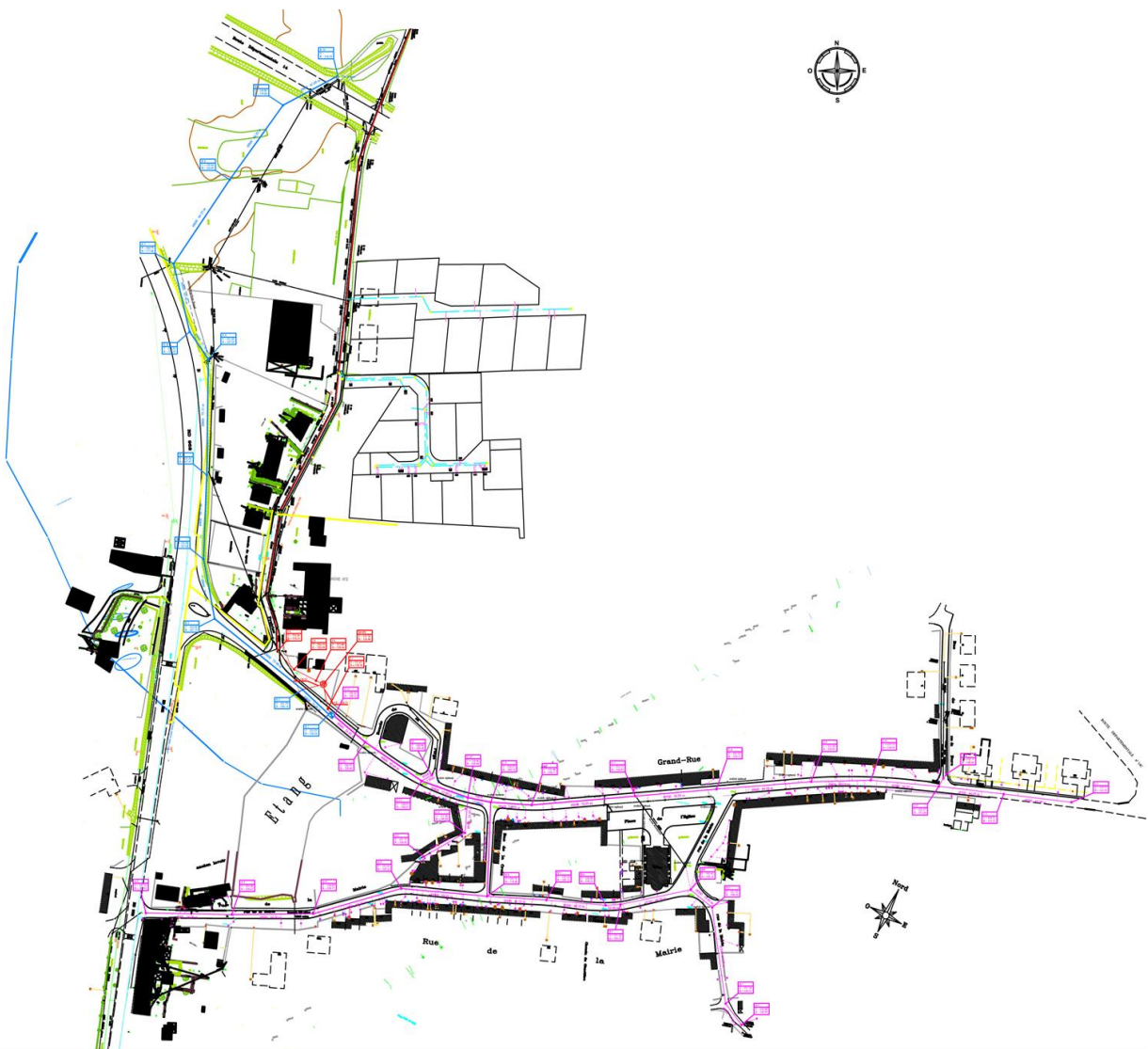
Plan du réseau d'assainissement
