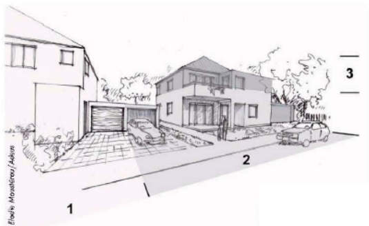
Exemple de construction dense en dent creuse : maison jumelées et superposées
