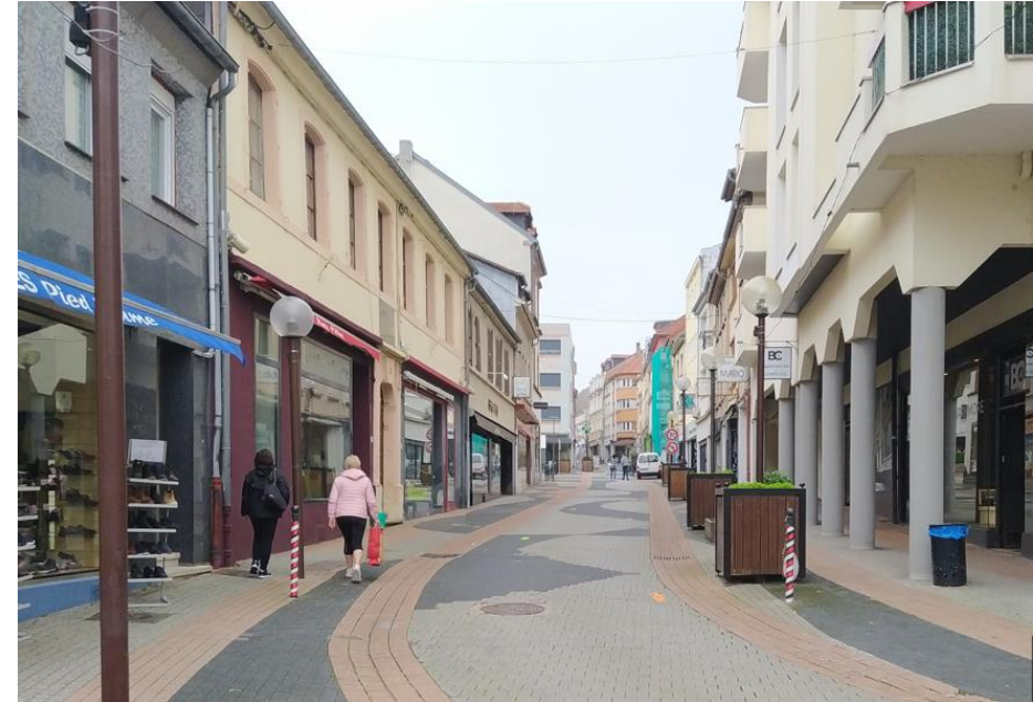
Rue Nationale : utilisation de matériaux qualitatifs et présence d'arbres. L'utilisation de pavés, la différenciation entre l'espace piéton et la voirie, et l'usage parcimonieux de mobilier de sécurité, facilite l'appropriation de l'espace public par les habitants et les visiteurs
