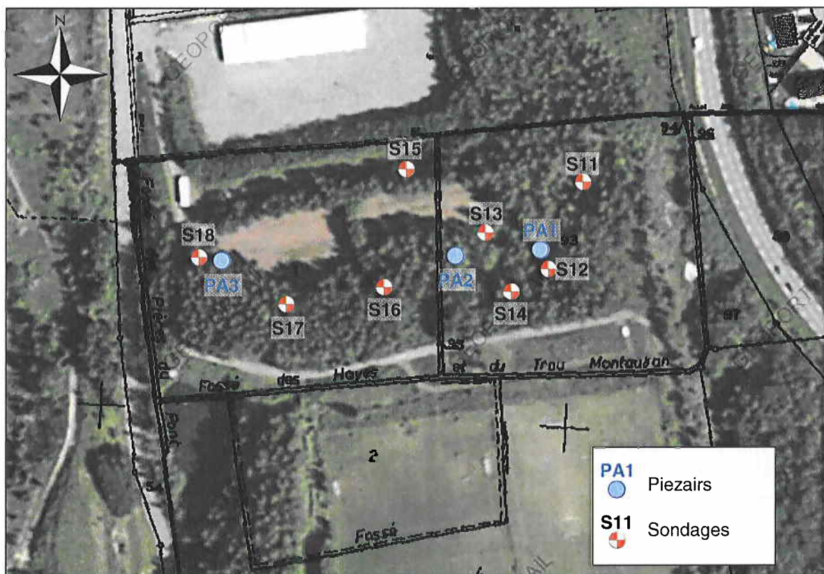
Figure 9 : Implantation des sondages et piézairs
