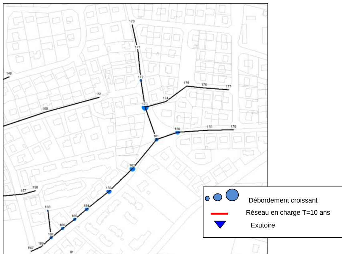
Figure 66 : Débordements à Ty Er Park pour une pluie 10 ans
