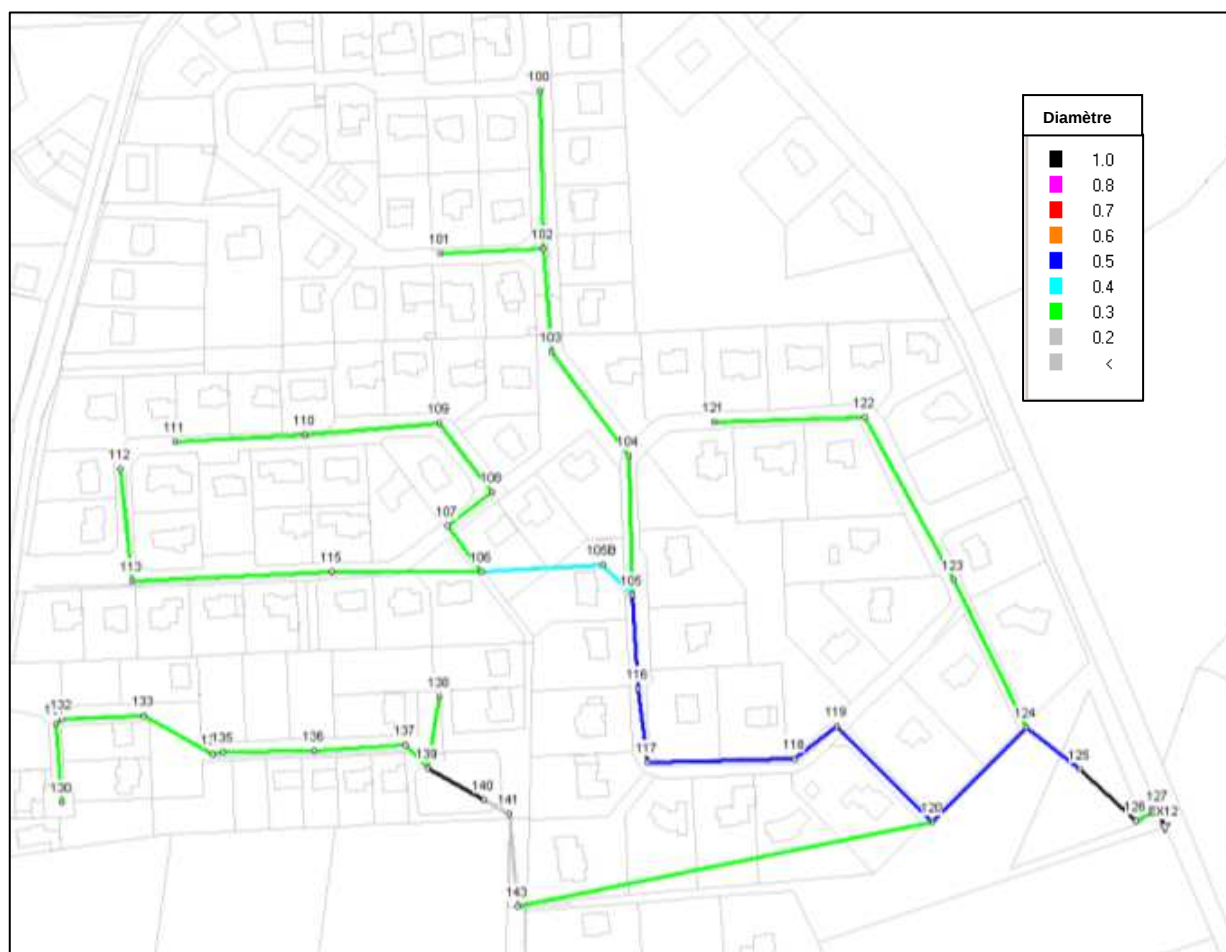
Figure 75 : Plan du réseau du bassin versant de Mon Plaisir
