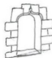
Lintheau en accolade
