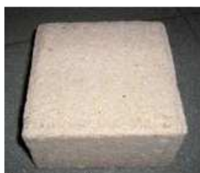
Pavés en béton poreux
