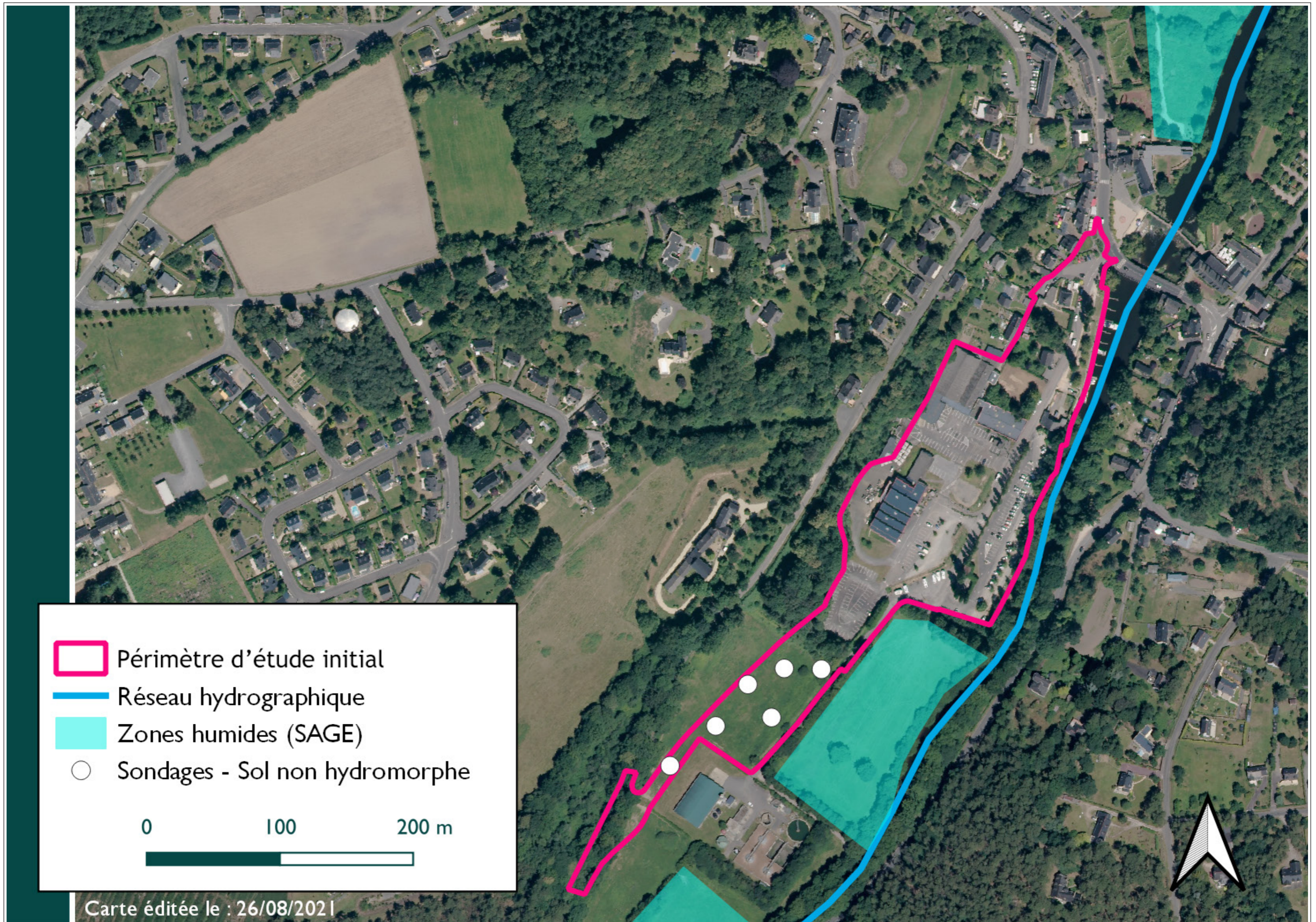
Fig. 38 : Carte extrait de l'inventaire des zones humides et repérage des points de sondage à l'échelle du périmètre de projet
