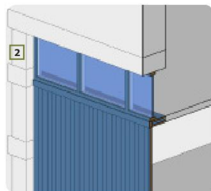
Les planches de l'imposte et de l'ouvrant sont identiques et alignées en prolongement les unes des autres.
