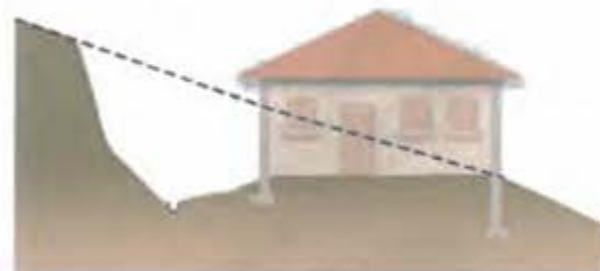
Plate-forme en déblais
