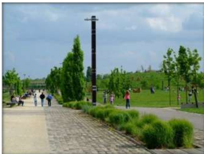
← Parc de Seille à Metz : Récupération des eaux en partie centrale (arrosage naturel des plantes)
