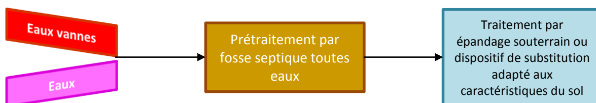
Figure 15 : Schéma d'une installation d'assainissement non collectif
