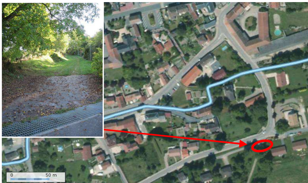
Fig. 18 : Grille de collecte en bas du Chemin Creux
