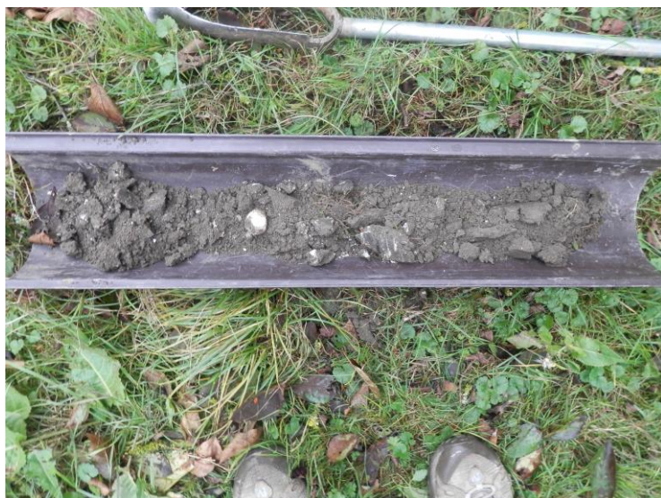
Figure 8 : profil de sol du sondage 3.
