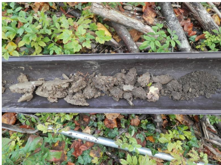
Figure7 : profil de sol du sondage 3.
