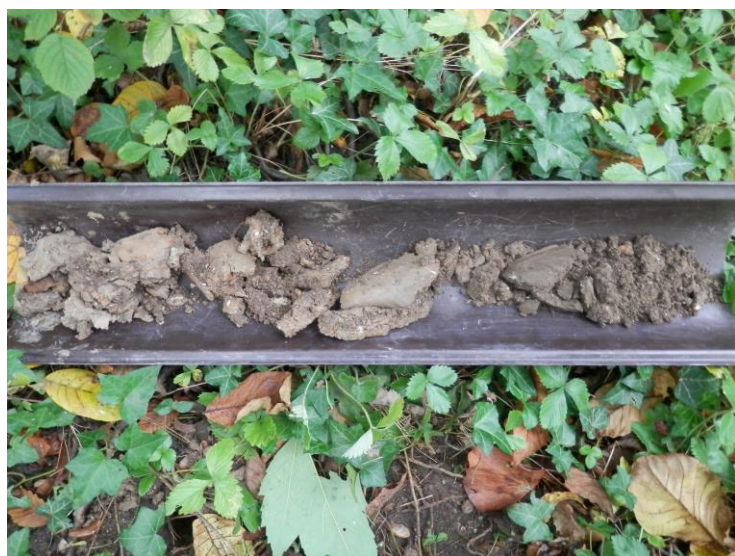
Figure 5 : profil de sol du sondage 1.
