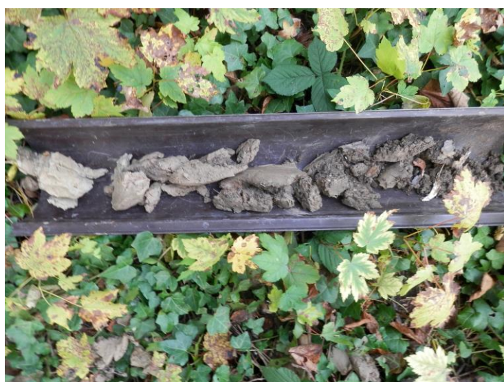
Figure 6 : profil de sol du sondage 2.
