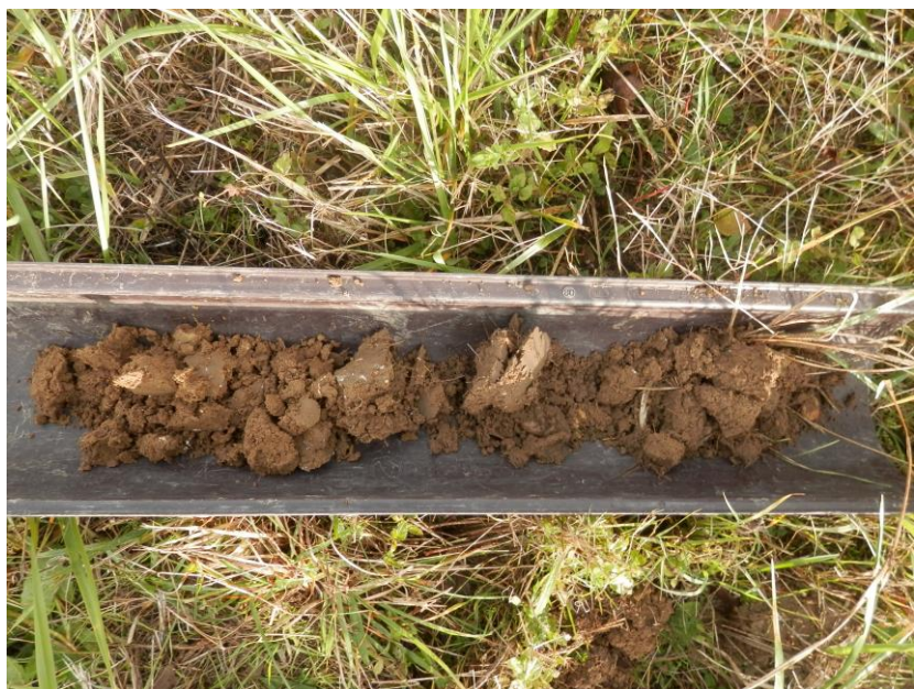
Figure 7 : profil de sol du sondage 2.
