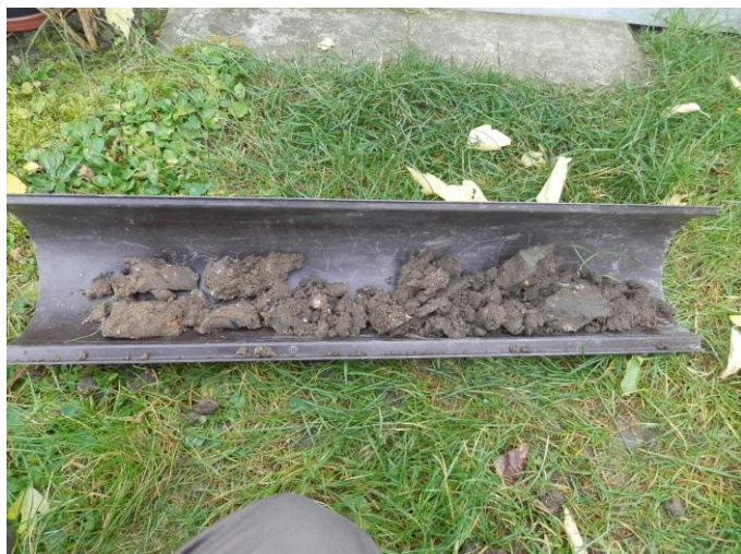
Figure 7 : profil de sol du sondage 1
