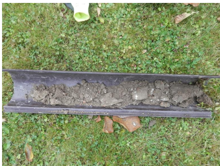
Figure 6 : profil de sol du sondage 1.
