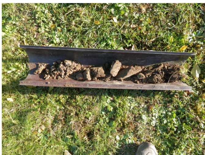
Figure 9 : profil de sol du sondage 3
