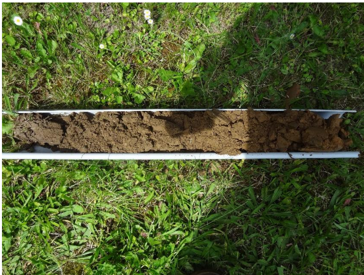
Figure 6 Profil du sol du sondage
